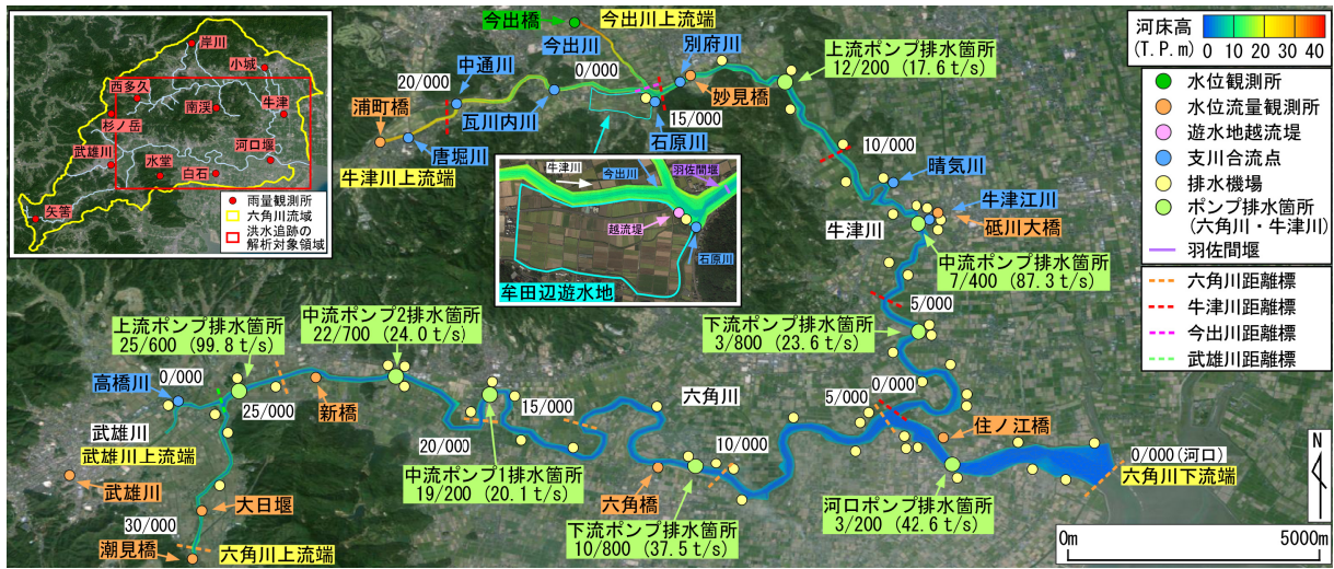
図-1 六角川流域の概要と解析対象領域および境界条件の設定位置
