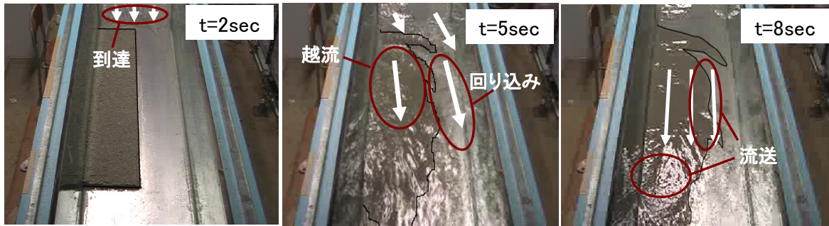
図-5 ゲート開放後の流況写真(左からゲート開放 2, 5, 8 秒後)
