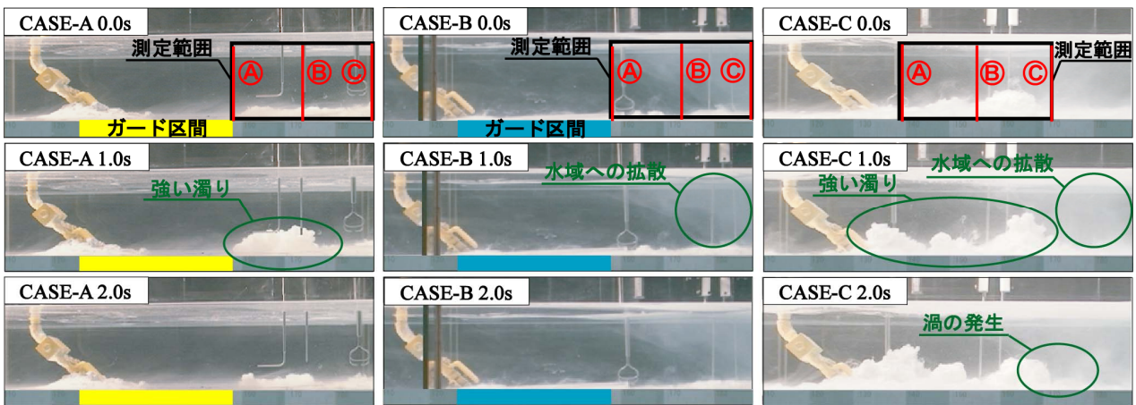
図-2 濁りの拡散状況 (上から t=0.0, 1.0, 2.0s)
